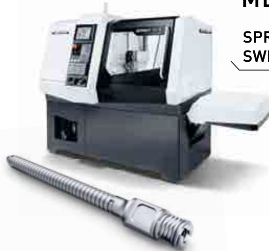
KNOCHENSCHRAUBE Maße: \varnothing 10 \times 85 mm Material: Titan (Ti6Al4V)
