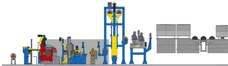
Dann geht es los: Der Streifen wird in eine Lösung getaucht, die Kupferionen enthält. Durch einen komplexen elektrochemischen Prozess, der als galvanische Beschichtung bekannt ist, wird das Kupfer auf den Stahl übertragen. Je länger der Strom fließt, umso dicker wird die Kupferauflage auf dem Stahlband. Die Schichtstärke auf dem Trägerband wird in Mikrometern ( $\mu\text{m}$ ) gemessen und ist der Hauptbestandteil unserer Leistung.
