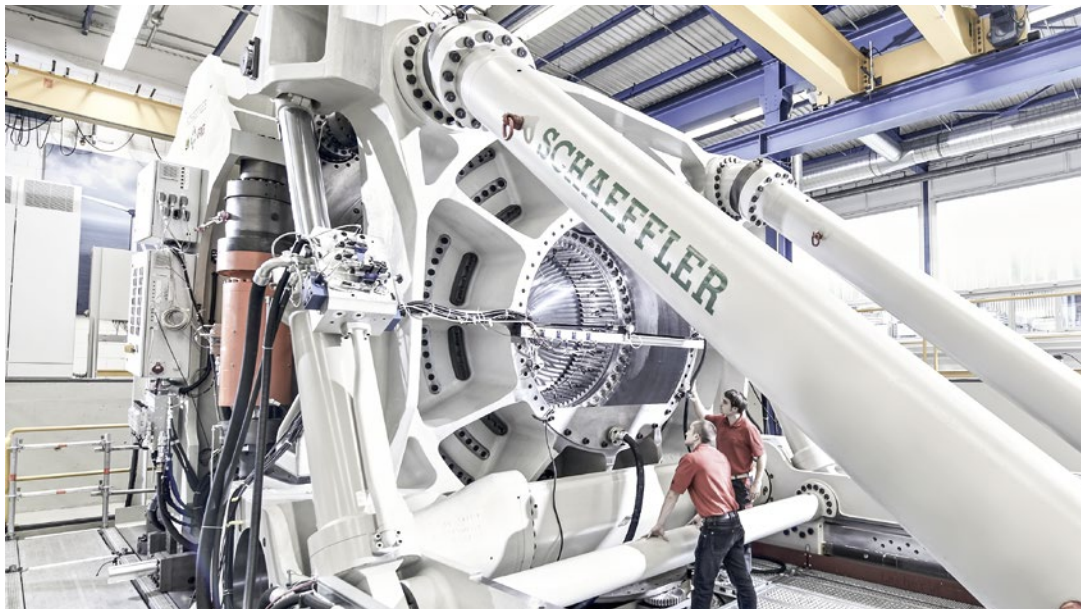
Meterware: Großlager- prüfstand Astraios in Schweinfurt
